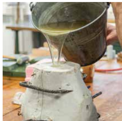
Ausgießen der Silikonform mit heißem Wachs
