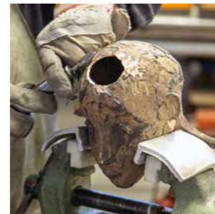
Ziselieren und Feinbearbeitung der Oberfläche
