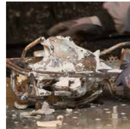
Säuberung des Rohgusses vom Schamotte
