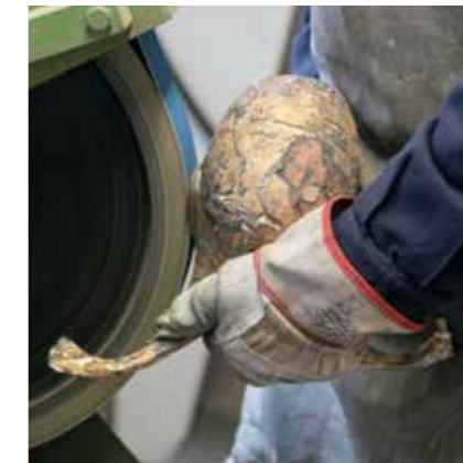
Entfernen der Angusskanäle
