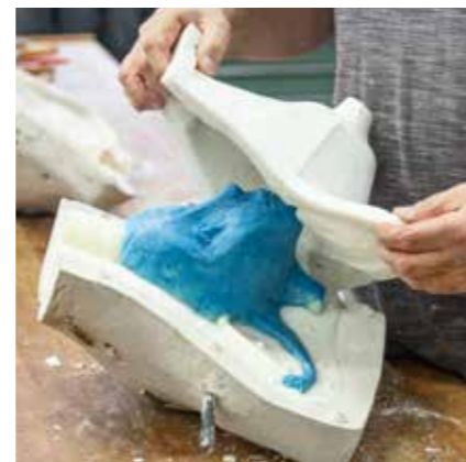
Entnahme des fertigen Wachsmodells
