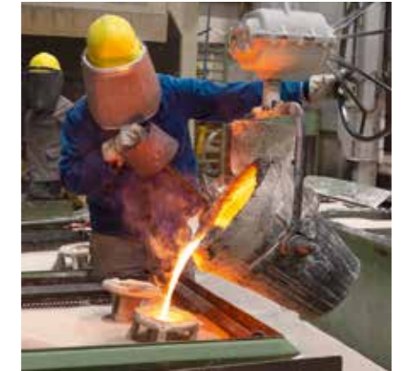
Der Guss im Wachsaußschmelzverfahren
