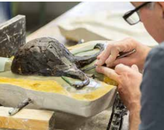
Abformen des in 8 Segmente geteilten Modells
