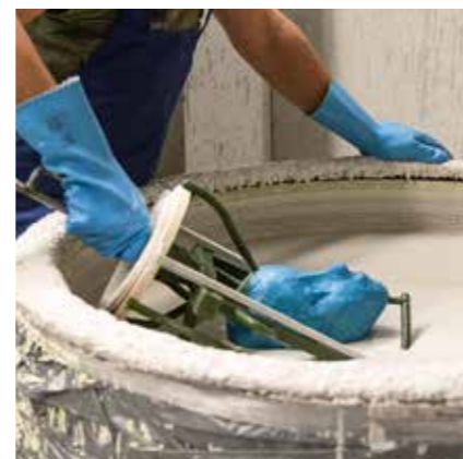
Umhüllung des Wachsmodells mit Schamotte
