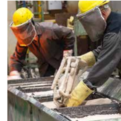
Einsetzen der Gussform in das Gießbett
