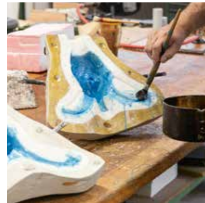
Auftragen der ersten Wachsschicht
