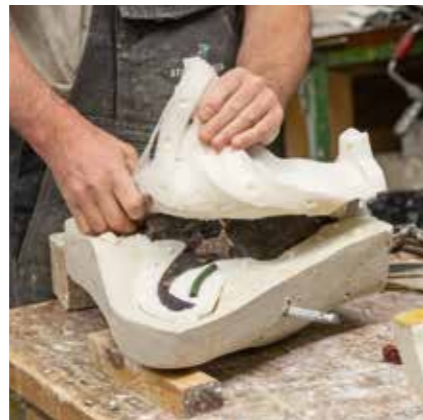
Die flexible Negativform aus Silikon
